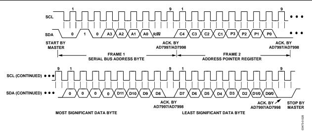
Figure 28. 2-Byte Write Sequence
