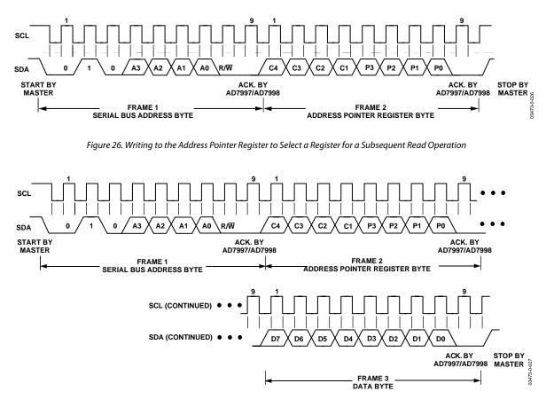
Figure 27. Single-Byte Write Sequence
