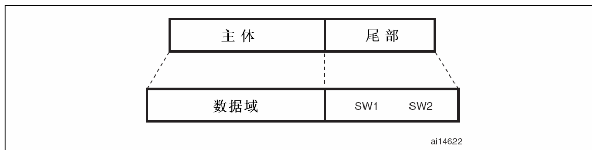
图8 响应APDU结构
